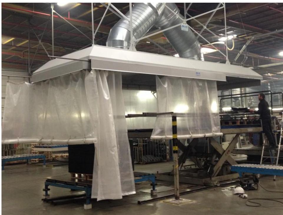
Figure 6 : Exemple de Chapelle d'aspiration (Source ACR Engineering)
